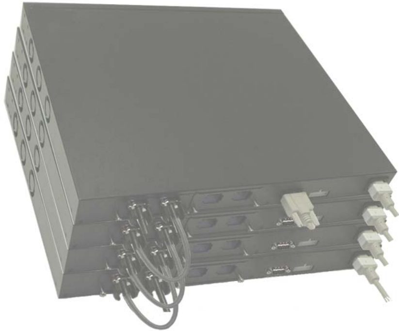
Figura 1-3. Conexión de una pila de conmutadores
